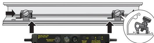
安装托架接上之前，螺钉必须已被拧松，将感应器装入壳并将两个安装托架拉上至感应器的位置。
