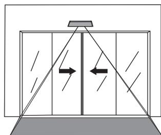
调试时为避免系统出现错误的背景信息，在整个自学习的过程中，所有有关背景物体（如：调试人员、梯子、工具箱等）必须撤出探测范围，感应器上电后，蓝色指示灯闪烁同时输出开门信号，进入学习背景状态，当感应器连续2S检测到稳定背景后，蓝灯快闪后，背景学习成功，蓝色指示灯长亮，释放开门信号，感应器进入待机状态。
