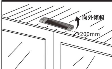
离门距离无法达到 $200\text{mm}$ 时，可将安全光幕向外倾斜一定角度安装。
