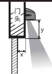
外挂安装时，为了避免感应器第一排红外线被门头挡住，门头底端到探头之间的距离确保满足以下条件：
