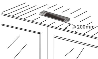
吸顶安装时，为了避免引起自感，移动门体与安全光幕之间安装间距确保要 $\geq 200\text{mm}$ 。
