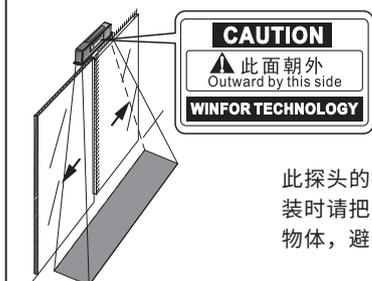
此探头的扫描范围具有单向性，实际安装时请把“此面朝外”标志侧朝向移动物体，避免产生自感。
