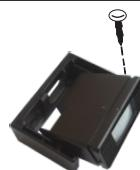
先固定底托架，然后转动感应器主体。
